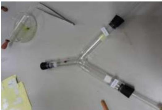
**Gambar 2.** Pemasangan olfaktometer untuk menguji repelen atau atraktan (Sumber : Dadang dan Prijono 2008)
