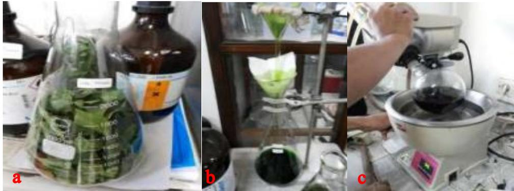
**Gambar 1.** a. Daun yang siap direndam dengan methanol b. hasil rendaman disaring c. hasil saringan dilakukan rotary evaporator
